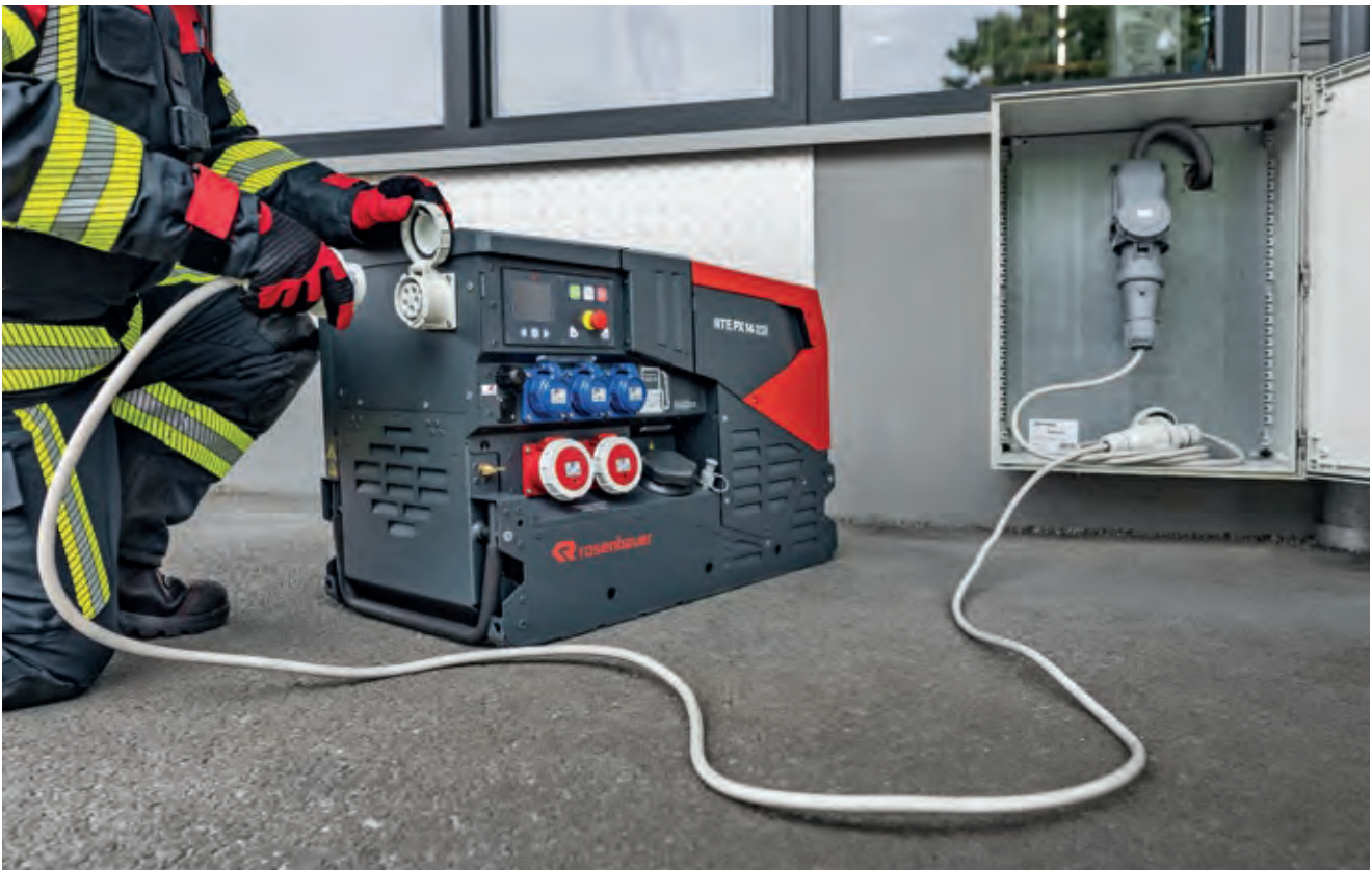
RTE PX 14 mit Verbindungsleitung zur Einspeisevorrichtung am Objekt.
