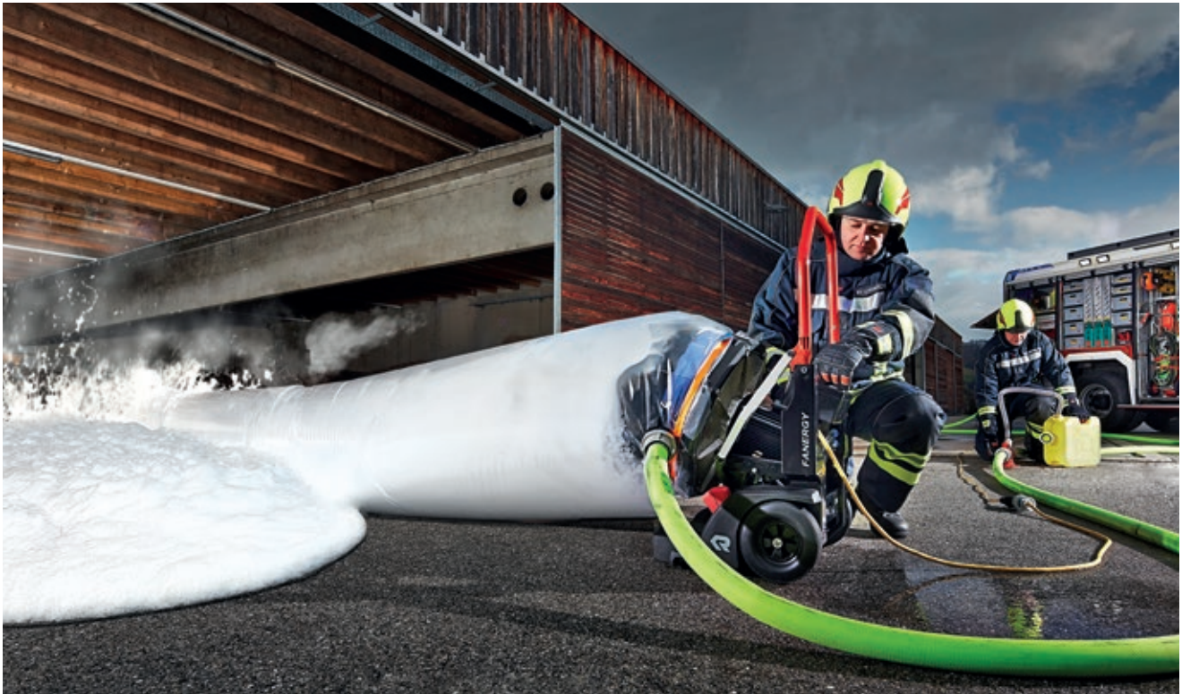
Mit Schlauchlute, um Schaum in Keller und unterirdischen Anlagen einzubringen.
